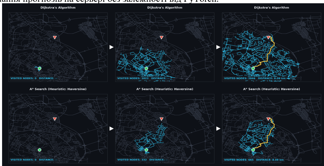
Рис. 2. Візуалізація роботи алгоритмів Дейкстри та A* з гаверсинусовою евристикою на фрагменті дорожньої мережі м. Києва
