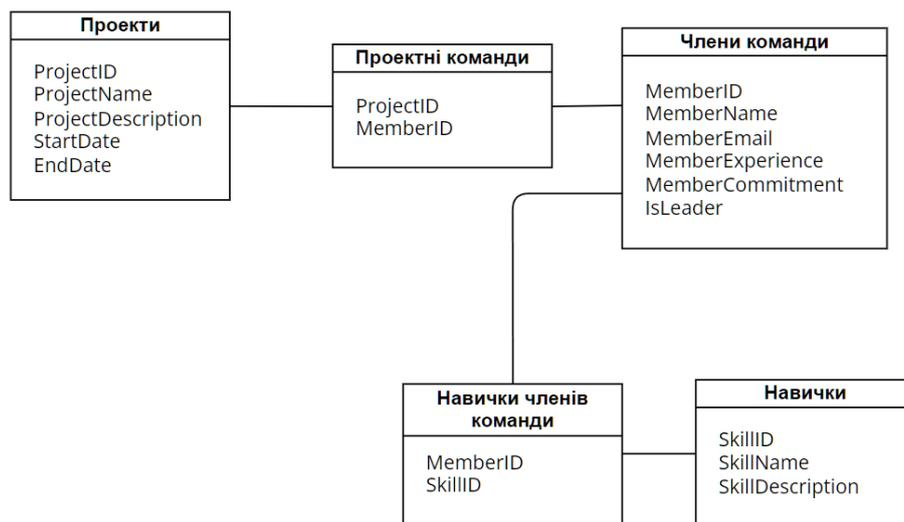
Рис. 2. Структура бази даних інформаційної технології креативного управління ІТ-проєктами
